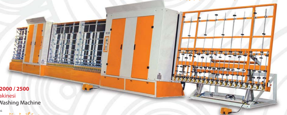
ACWM 1700 / 2000 / 2500 Otomatik Birleştirmeli Panel Presli Cam Yıkama Hattı Automatic Combining and Panel Press Glass Washing Line خط اوتوماتيكي لعمل الزجاج العازل مزود بغسالة دستگاه اوتوماتيک شستشو و پرس
